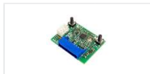
H93/RX2LP/I 205,00 zł Radioodbiornik 2-kanalowy 433,92 MHz ze złączem molex do central Roger z kodem stałym/zmiennym tylko do central "LOW POWER"
