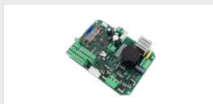
B70/1THP 1.440,00 zł Centrala sterująca 1 silnikiem brushless 36 V AC, do automatów bram garażowych
