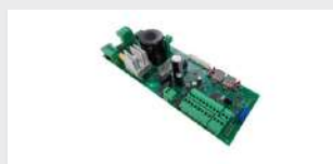
B70/1DCHP 1.280,00 zł Centrala sterująca 1 silnikiem beszczotkowym 36 V AC, do automatów bram przesuwanych
